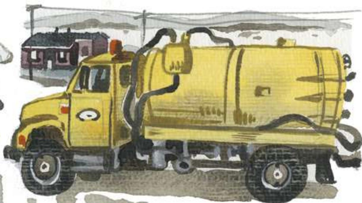
Le permafrost permet difficilement la pose de canalisations. Ce sont des camions citernes qui alimentent et vident les cuves.
